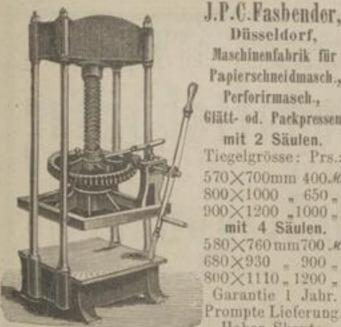
J.P.C. Fashender, Düsseldorf, Maschinenfabrik für Papierschneidmasch., Perforirmasch., Glätt- od. Packpressen mit 2 Säulen. Tiegelgrösse: Prs.: 570×700mm 400.46 800×1000 , 650 , 900×1200 ,1000 , mit 4 Säulen. 580×760 mm700 M
