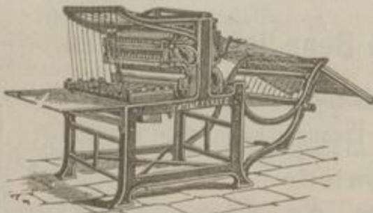
Diese Maschine, welche sowohl mit einem automatischen Einlegeapparat, als auch ohne solchen geliefert wird, zeichnet sich vor allen anderen Liniirmaschinen besonders dadurch vortheilhaft aus, dass sie jede Art Liniaturen, sowohl durchgehend, als auch abgesetzt, in verschiedenen Farben, auf beiden Seiten gleichzeitig, mit der grössten Sicherheit und Akkuratess erzeugt. [22963]
