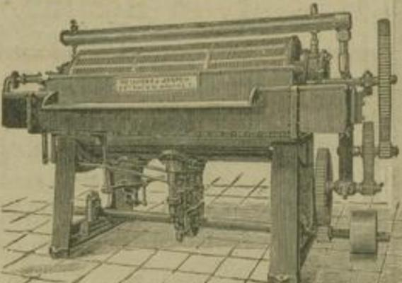
Flache Knotenfangapparate in jeder Construction. Knotenfangplatten mit und ohne Rippenverstärkung, in der saubersten und genauesten Ausführung.
