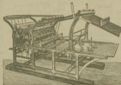
liniirt auf beiden Seiten gleichzeitig in 1 bis 3 Farben durchgehende u. abgesetzte Liniaturen, mit oder ohne Randlinien. In Leistung u. sicherem Aufeinandertreffen der Linien unübertroffen; die Bedienung erfordert nur eine Person. Liniirmaschine mit Querschneideapparat liniirt Rollenpapier und schneidet Schul-, Kanzlei- u. Postform.
