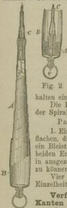
Der Stiel des Halters besteht aus einem spiralförmig gewundenen Blechstreifen *A*, der in gebrauchsfähigem Zustand des Halters auseinandergezogen und durch eine leichte Linksdrehung festgestellt ist, jedoch auch zusammengeschoben und in der Hülse *B* durch den federnden Haken *v* (Fig. 2) festgestellt werden kann, wenn der Halter in der Tasche getragen werden soll. An dem oberen Ende des Blechstreifens *A* ist eine Vorrichtung *C* bekannter Konstruktion zum Festhalten einer Bleimine befestigt.
