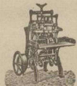
Mit selbstthätiger Gummirung der Unterklappe.
