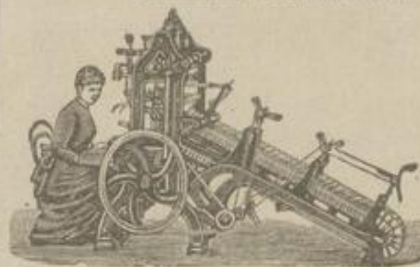
Mit selbstthätiger Gummierung better Klappen also auch der Schlussklappen.
