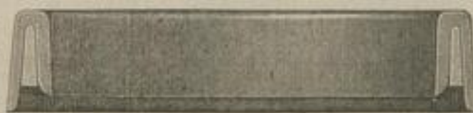
Querschnitt einer Manschette mit Gummi-Einlage.
