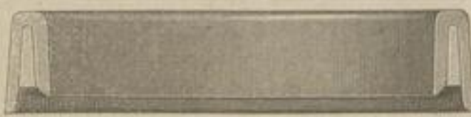
Querschnitt einer Manschette mit Gummi-Einlage.
