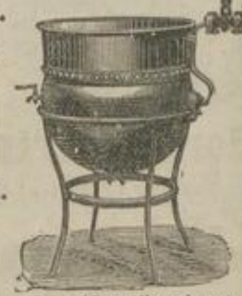
Dampf-Doppelkessel zum Leimauftragen.
