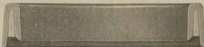
Querschnitt einer Manschette mit Gummi-Einlage.
