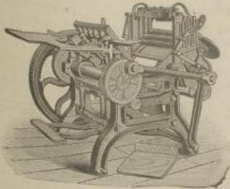
**Neu:** Die Liberty mit patentirter Vorrichtung zur sofortigen Abstellung des Druckes bei jeder Stellung des Tiegels.
