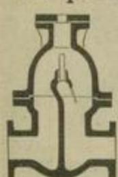
Bei D eintretender nasser Dampf wird durch die Scheidewand nach unten geleitet, verlangsamt in der unteren Glocke seine Geschwindigkeit, lässt die Wassertheilchen hier fallen und entweicht, befreit davon, nach R. Zum Ablassen des Wassers wird unten ein Hahn oder ein Dampfwasser-Ableiter angeschlossen.
