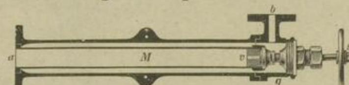
In einem Eisenrohr sitzt ein oben und unten offenes Messingrohr, welches sich, sobald Dampf darin steht, ausdehnt und auf einem Ventil abdichtet. Sobald sich indess Dampfwasser bildet, kühlt sich das Messingrohr ab, kürzt sich und öffnet das Ventil für den Abfluss.
