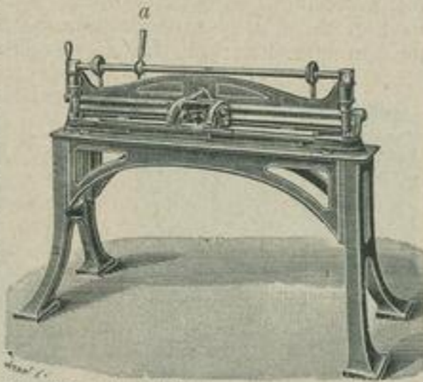
Fig. 29. Abschärf-Apparat zum Profiliren der Pappkanten.
