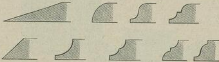
Fig. 28. Verschiedene mit dem Abschärf-Apparat Fig. 29 hergestellte Profile an Pappkanten.
