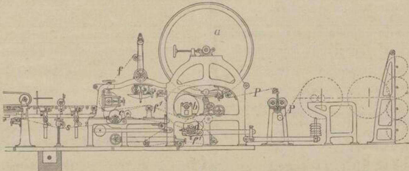
D. R. P. No. 64060. **Stroh- und Seidenpapiermaschinen neuester Construction** D. R. P. No. 64060.
