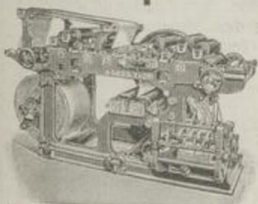
Einfache Schnellpressen mit hohem und comb. Cylinderfarbwerk mit Eisenbahnbewegung, und neue Construction mit zwangsläufiger Rollenbewegung,
