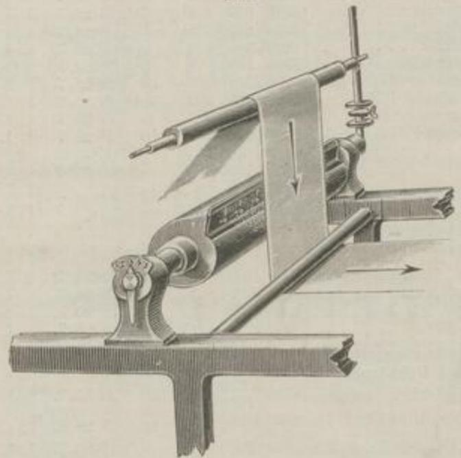
Einspreng-, Aufspritz- und Anfeuchtmaschine Patent Kron, D. R. P. No. 41,401.
