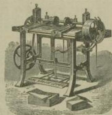
**Dampf-Kanten-Abschräge- und Abrunde-Maschine,** zum Abschrägen und Abrunden der Pappdeckel-Kanten.
