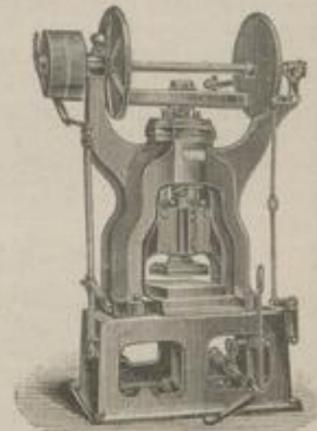
Balancier für Dampftrieb.
