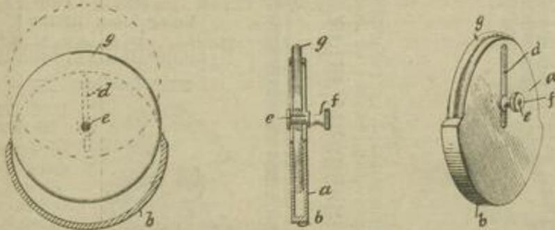
flachen Seitenwände *a* des Gehäuses sind elastisch, sodass sie dicht an den Gummi herangepresst werden können. Sobald der aus dem Gehäuse hervorragende Rand des Gummis verbraucht ist, schiebt man letzteren weiter vor und klemmt ihn mittels einer Schraube *ef* in dem Gehäuse fest. Die Schraube ist im Mittelpunkt des anfänglich kreisförmigen Gummis angeordnet und führt sich in zwei Schlitzten *d* des Gehäuses.
