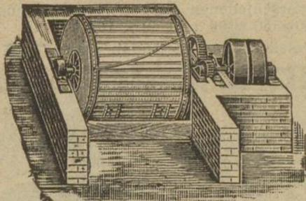
Durch diesen Apparat wird jede Holzart ohne Verlust an Holz von der Rinde vollständig befreit.
