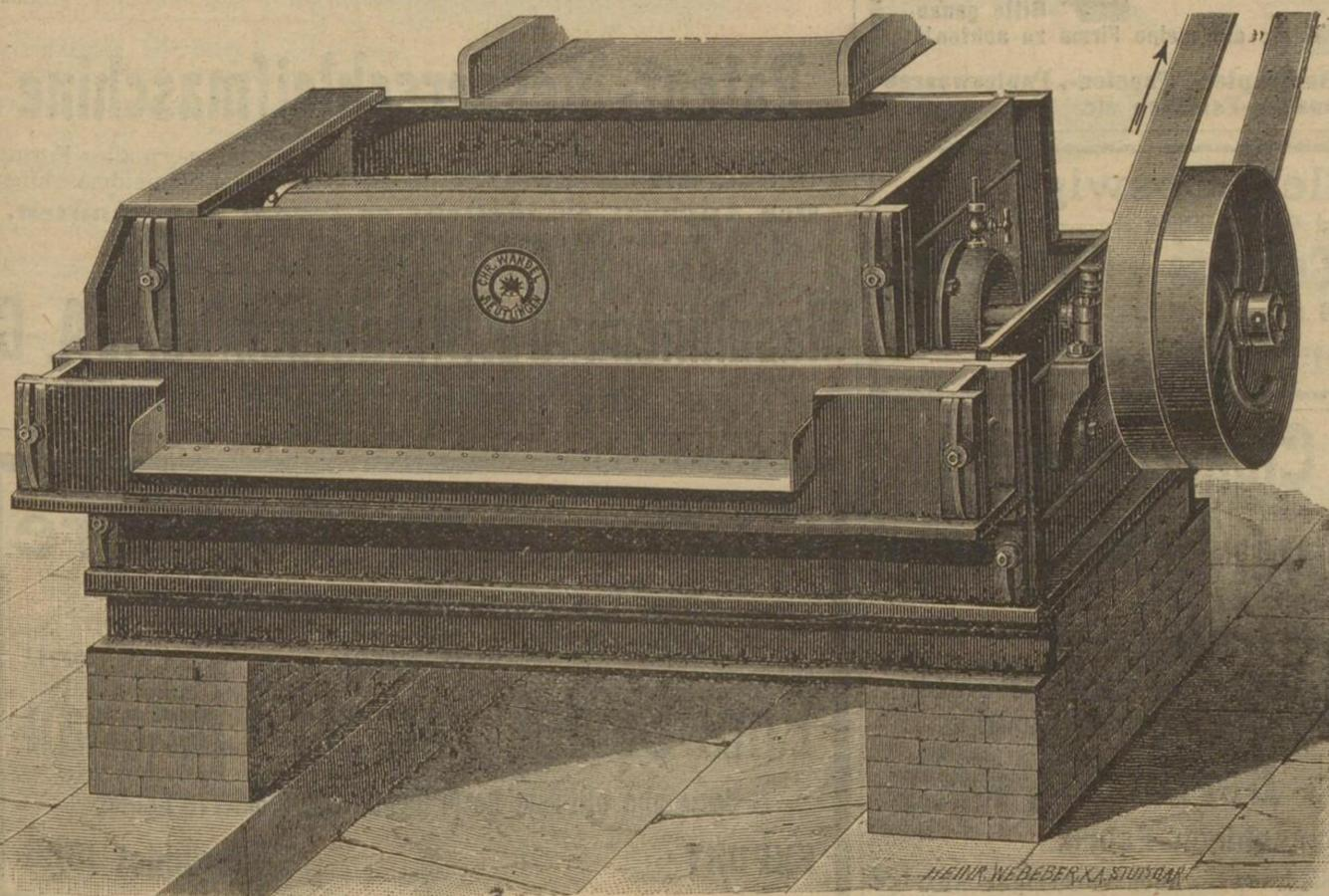
Die schräg zur Cylinderachse verlaufenden, schraubenartig geformten Metallschaufeln (D. R.-Pat. 99084) treiben den sortirten Stoff im Cylinder beständig den seitlichen Ausgüssen zu, wodurch
