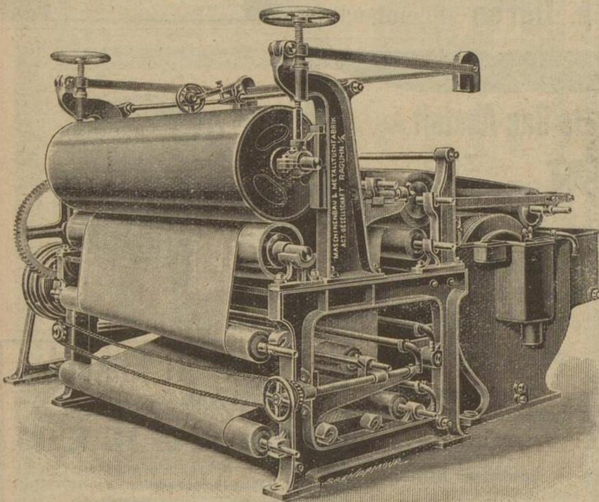
Pappenmaschinen und Stoff-Entwässerungsmaschinen, Rundsieb-Papier- und Cartonmaschinen bewährter Construction, mit jeder Anzahl Rundsieben.
