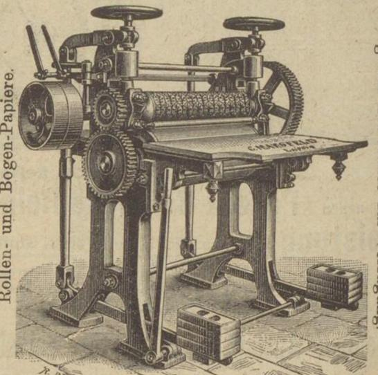
Auf Wunsch Einrichtung für durch Gas oder Dampf heizbare Stahlwalze. Für Rollen- und Bogen-Papiere.
