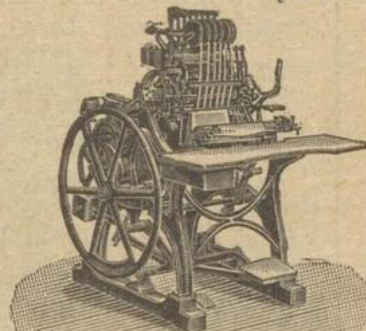
Neue Faden-Heftmaschine zum Heften von Verlags-Werken auf Gaze oder Band, sowie zum Holländern von Broschüren.
