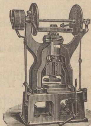
Balancier für Dampftrieb
