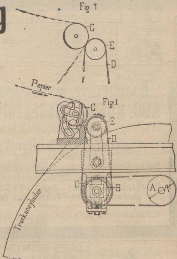
Die Vortheile dieser Vorrichtung sind hauptsächlich bei schnelllaufenden Maschinen oder bei der Fabrikation dünner Papiere unbezahlbar, da der Ausschuss beim Durchführen von den Pressen auf die Trockenpartie auf ein Minimum beschränkt wird.
