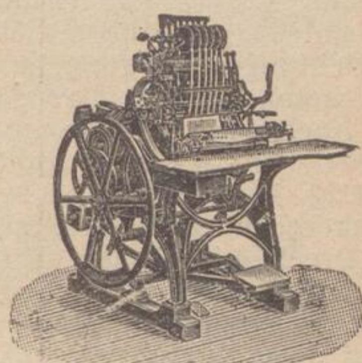
Neue Faden-Heftmaschine zum Heften von Verlags-Werken auf Gaze oder Band, sowie zum Holländern von Broschüren.
