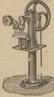
Bogen-Falzmaschine für 1-5 Brüche mit Präzisions-Auslege-Vorrichtung F. 101
