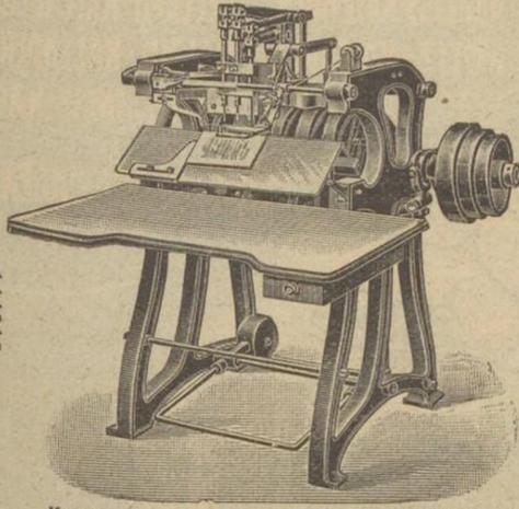
Knoten-Faden-Heftmaschine Modell GG/1003.
