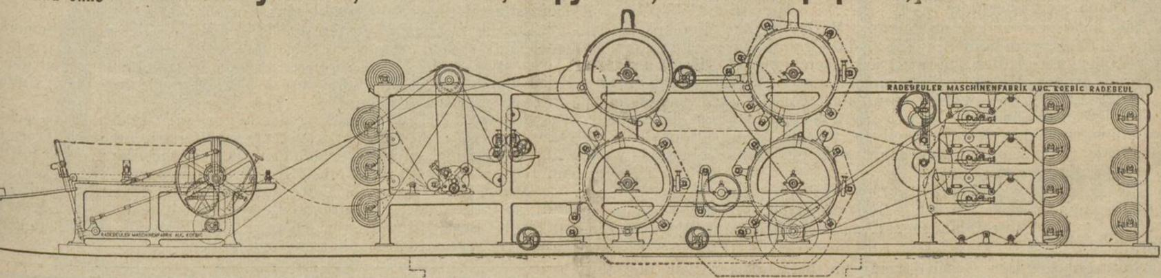
(An icht einer Rollenklebmaschine für 2-4 Rollen, mit Reserverollen-Gestell, mit 4 Trockenzylindern, mit Anfeuchter, Aufrollvorrichtung und separat stehendem Querschneider) [144482]
