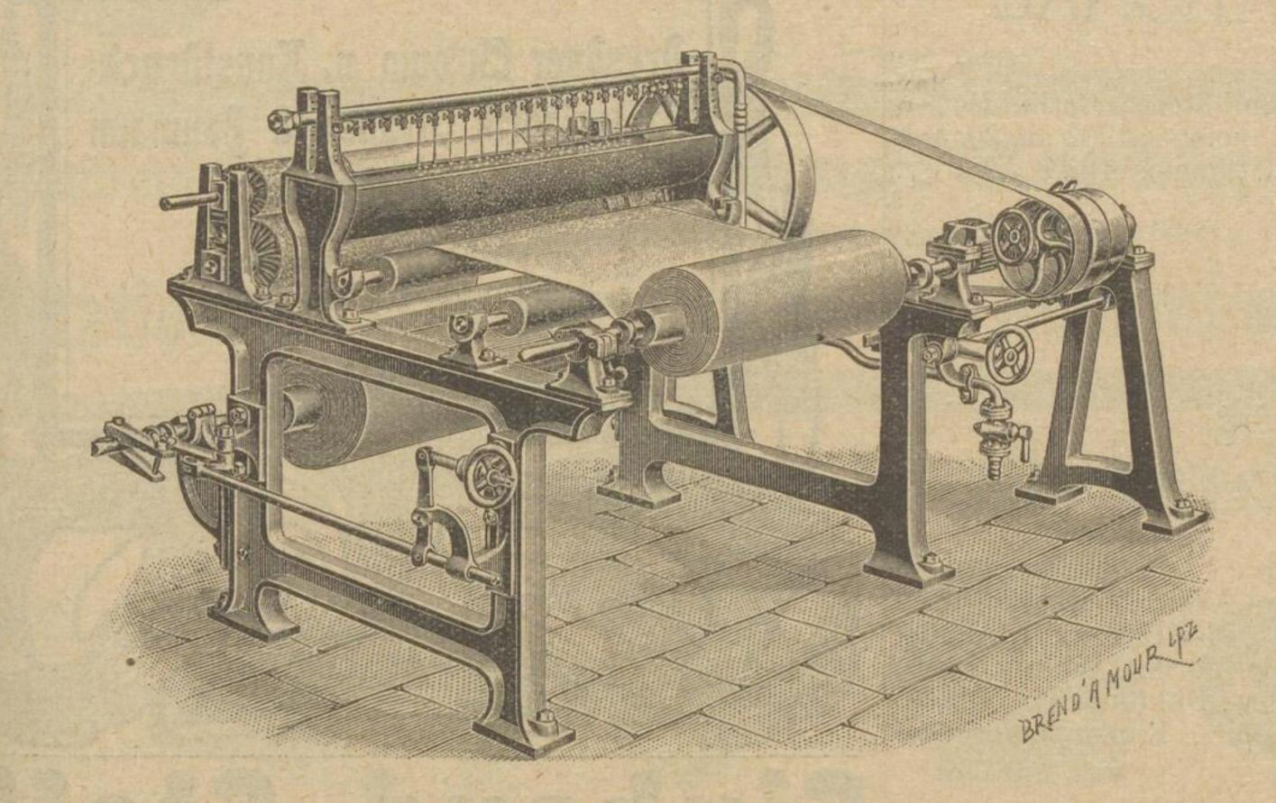
Rollen-Feuchtmaschine mit Spritzrohr- oder Bürstenfeuchtung.
