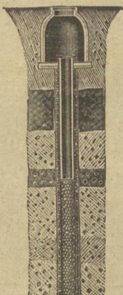
Volle Erschliessung der wasserführenden Erdschichten, daher: Grösste Erglebigkeit.
