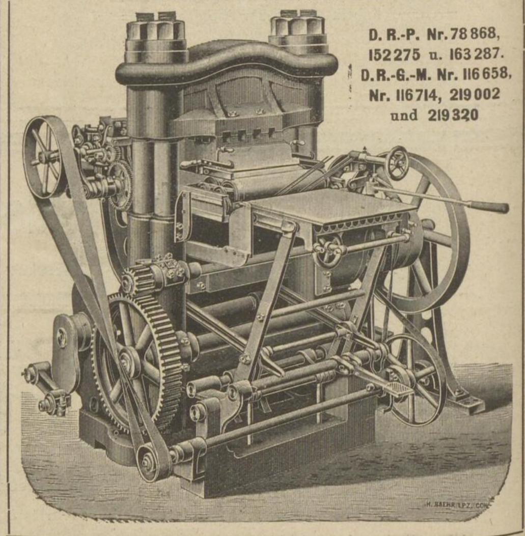
Das Farbwerk arbeitet nach dem unter Patentschutz stehenden Verfahren, bei welchem behufs Erzielung einer vollkommenen Einfärbung jede Auftragwalze nur einmal über die Gravur läuft.
