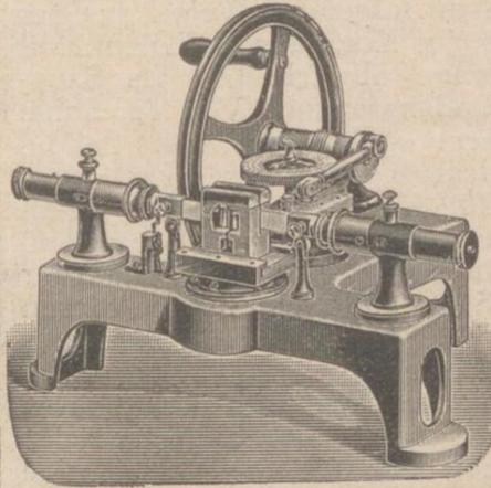
gibt Schopper's Falzer. Wertvoll für alle Fabriken, die Papiere herstellen, bei denen es auf Festigkeit ankommt, wie Normalpapiere, Packpapiere, Kabelpapiere usw. Im Kgl. Materialprüfungsamt 7 Stück in Gebrauch. Alle Prüfungsapparate und Wagen für die Papierindustrie in höchster Vollendung.
