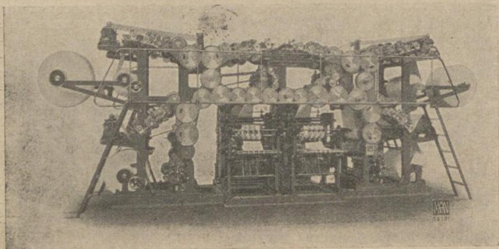
Bild 82. Vierrollen-Rotationsmaschine für 32seitige Zeitungen der Maschinenfabrik Augsburg-Nürnberg, Akt.-Ges.
