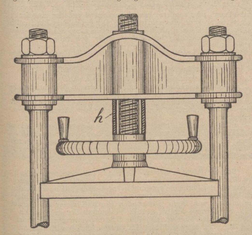
Zur Vermeidung ähnlicher Unfälle hat der Betrieb um die Spindel eine Hülse h gelegt, wodurch zwischen Handgriff und dem oberen Balken der Presse auch bei höchster Stellung des Schlagrades ein entsprechender Zwischenraum verbleibt.
