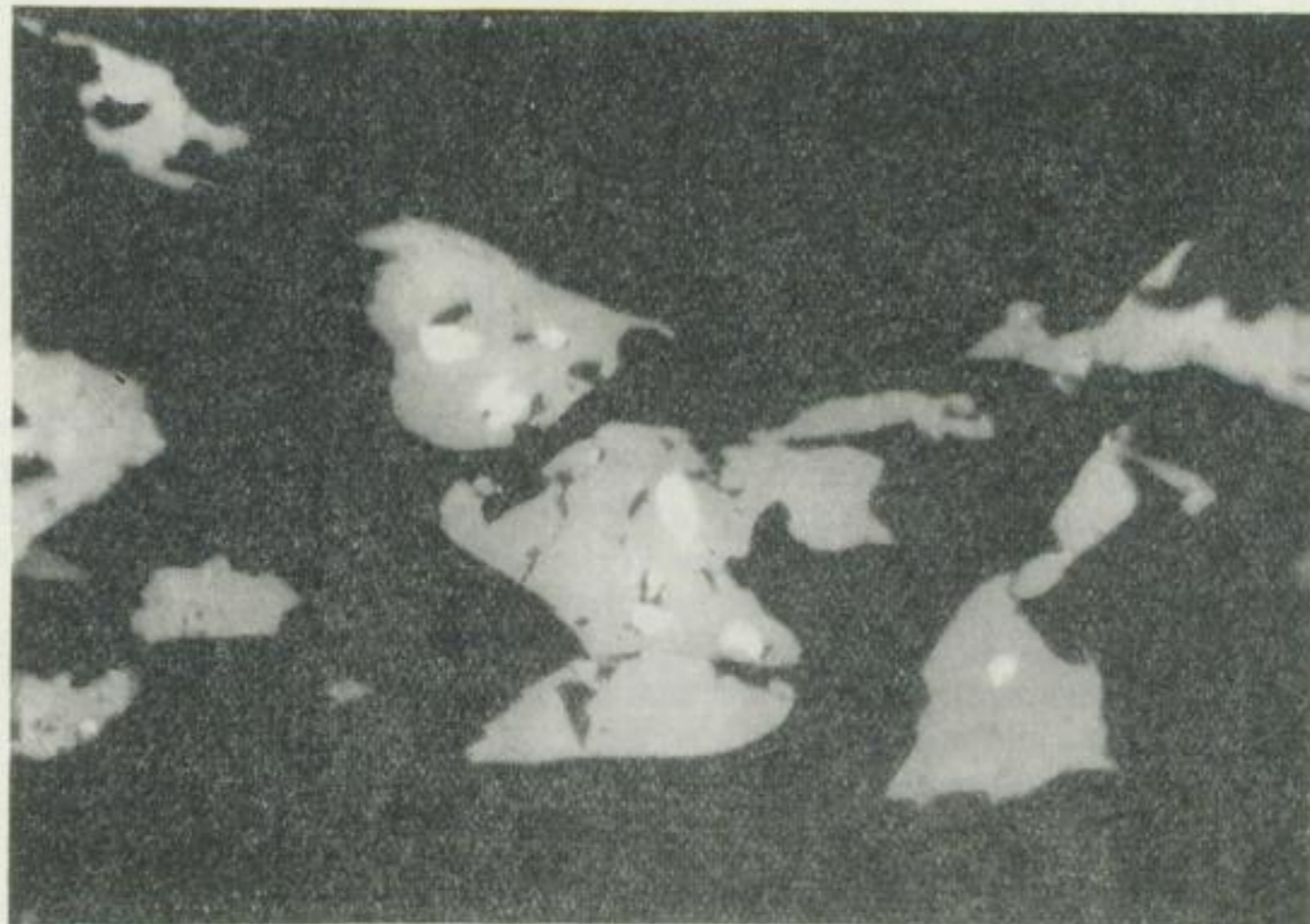
Bild 72. Titanit mit Ilmenitresten aus dem Biotit-Hornblende-granodiorit von Görzig (A 25, ohne Nicols, Maßstab 70 : 1)
