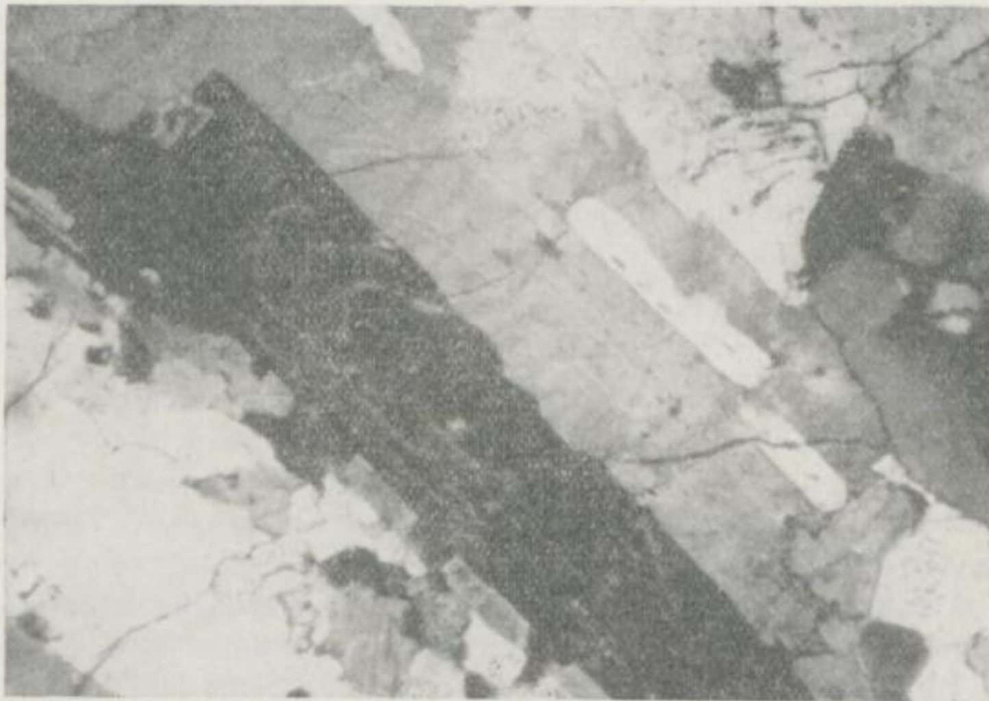
Bild 20. Als Karlsbader Zwilling ausgebildeter Kalifeldspat mit Anwachszonen aus dem Hornblendesyenodiorit nördlich von Pennrich (Blatt 65, D 65/23, gekreuzte Nicols, Maßstab 30 : 1)
