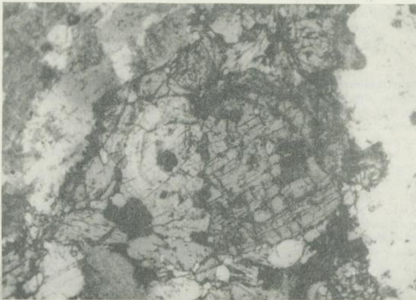
Bild 74. Diopsidkristall aus dem Pyroxensyenit der Bohrung Reudnitz (R 10, 156 bis 158 m Teufe, schräge Nicols, Maßstab 28 : 1)
