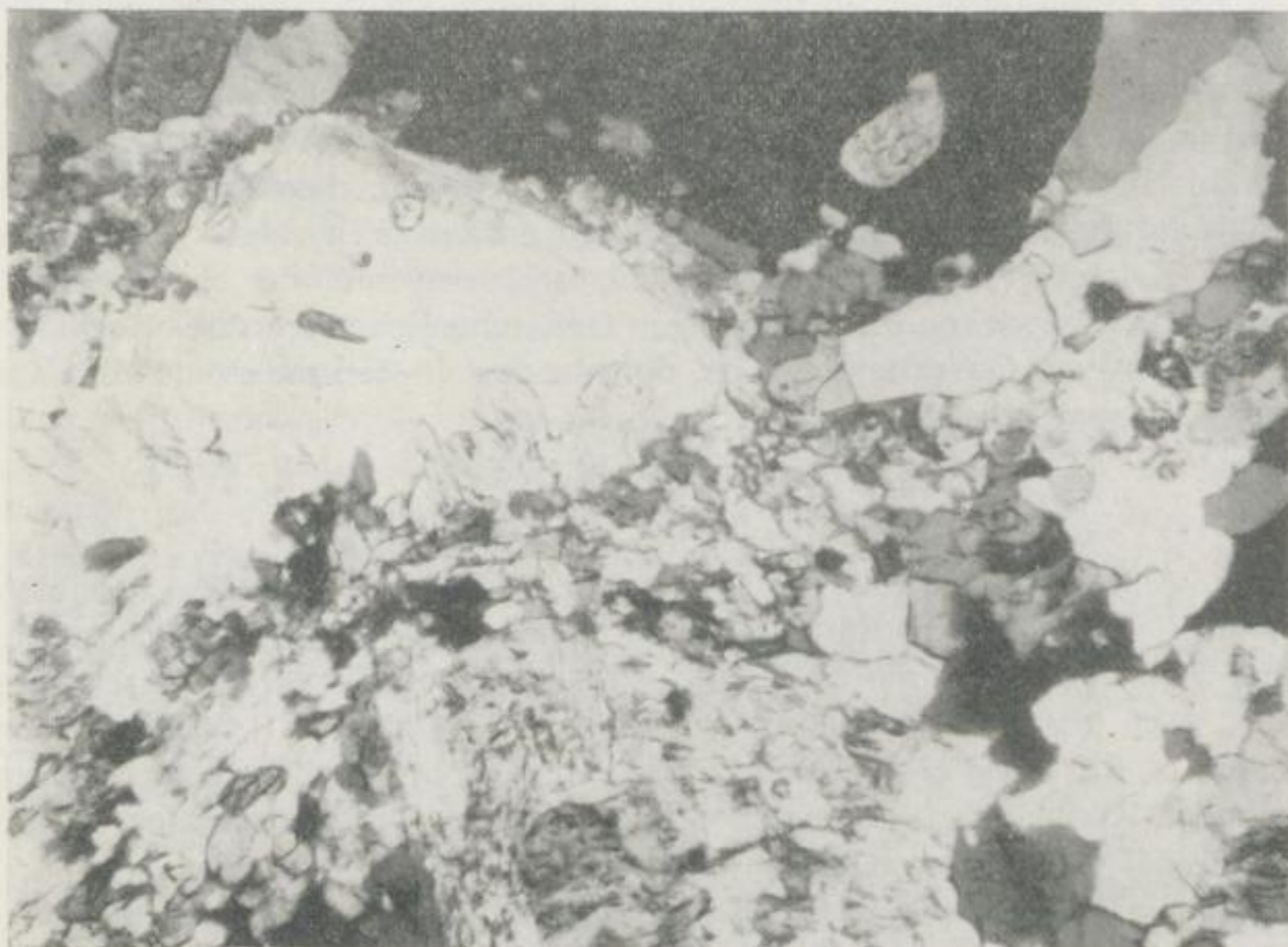
Bild 19. Wechselkörnige Partie aus dem Hornblendesyenodiorit südwestlich von Reinersdorf (Blatt 33) mit „Feinkornzug“ (D 33/36, schräge Nicols, Maßstab 32 : 1)
