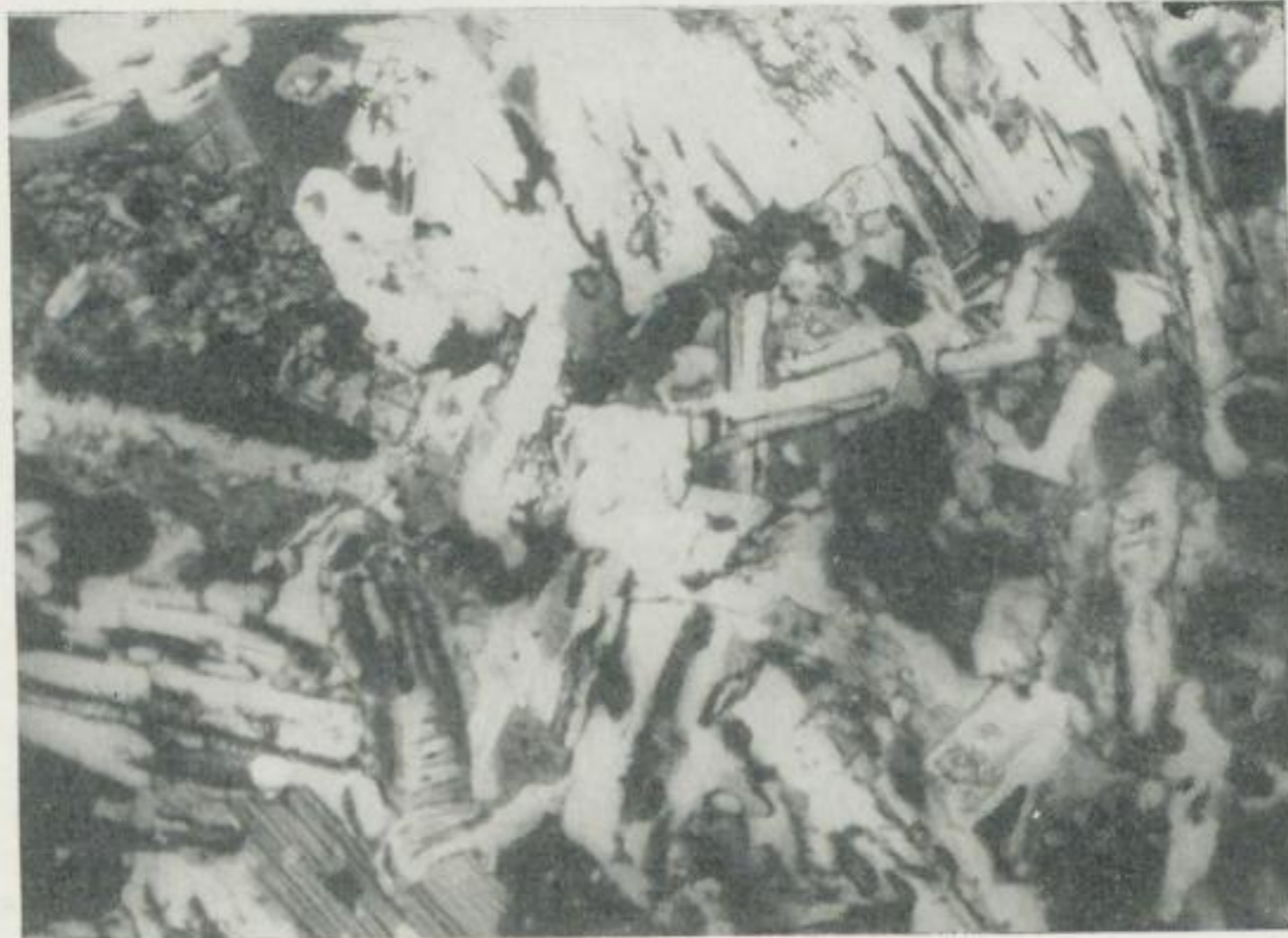
Bild 50. Sperriges Gefüge des Augitsyenodiorits vom Röhrsdorfer Teich (Blatt 82, D 82/59, gekreuzte Nicols, Maßstab 33 : 1)
