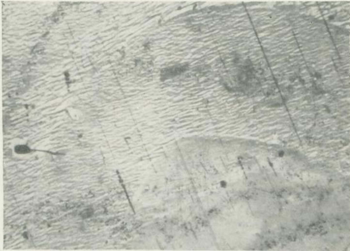
Bild 73. Kalifeldspat mit zonenweise unterschiedlich kräftig entwickelten Albitspindeln aus dem Pyroxensyenit der Bohrung Reudnitz (R 4, 55,5 bis 59,1 m Teufe, gekreuzte Nicols, Maßstab 175 : 1). Beachtenswert sind feine, im Bild schwarz erscheinende Rutilnadelchen
