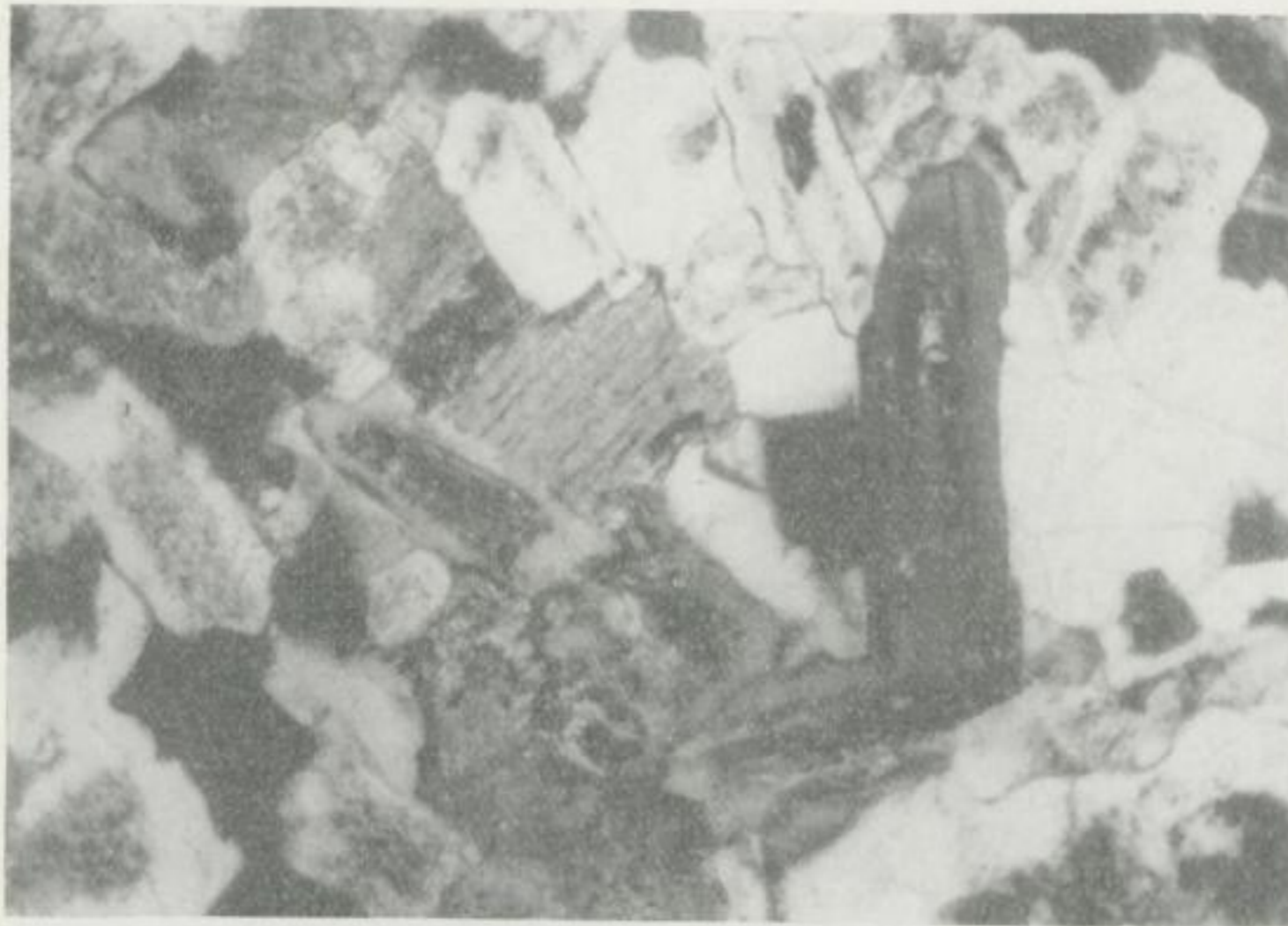
Bild 49. Biotit- und plagioklasreicher Einschluß aus dem Riesensteingranit (Stbr. am Bahngelände, D 48/70, gekreuzte Nicols, Maßstab 60 : 1)
