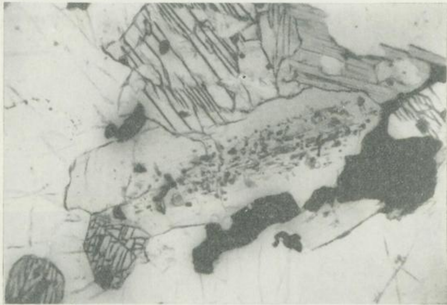
Bild 67. Diopsid mit Poikiloblasten von Ilmenit, Magnetit, Biotit und Kalifeldspat im Augitsyenodiorit von Gröba (D 16/53, schräge Nicols, Maßstab 420 : 1)
