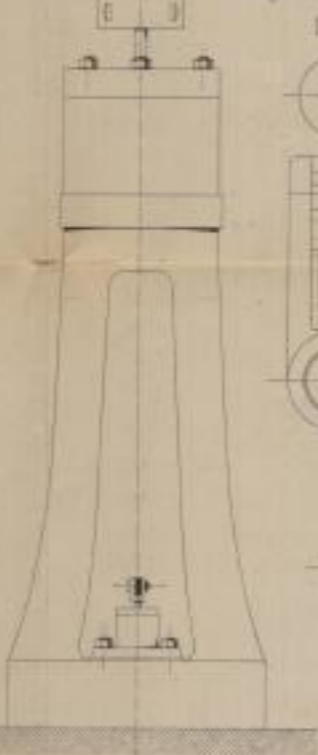
Fig. 10: Einspannvorrichtung für Biegung ex Tafel E Eisenbahnen & Maschinenfabrik Fourchambault.
