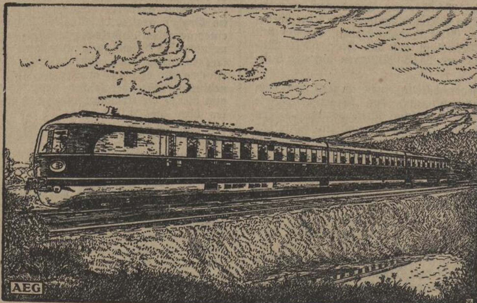
Auf der Strecke Berlin—Hamburg erreichte der dreiteilige elektrische Diesel-Schnelltriebwagen der Deutschen Reichsbahn eine Geschwindigkeit von 200 Stundenkilometern. AEG. (W.)
