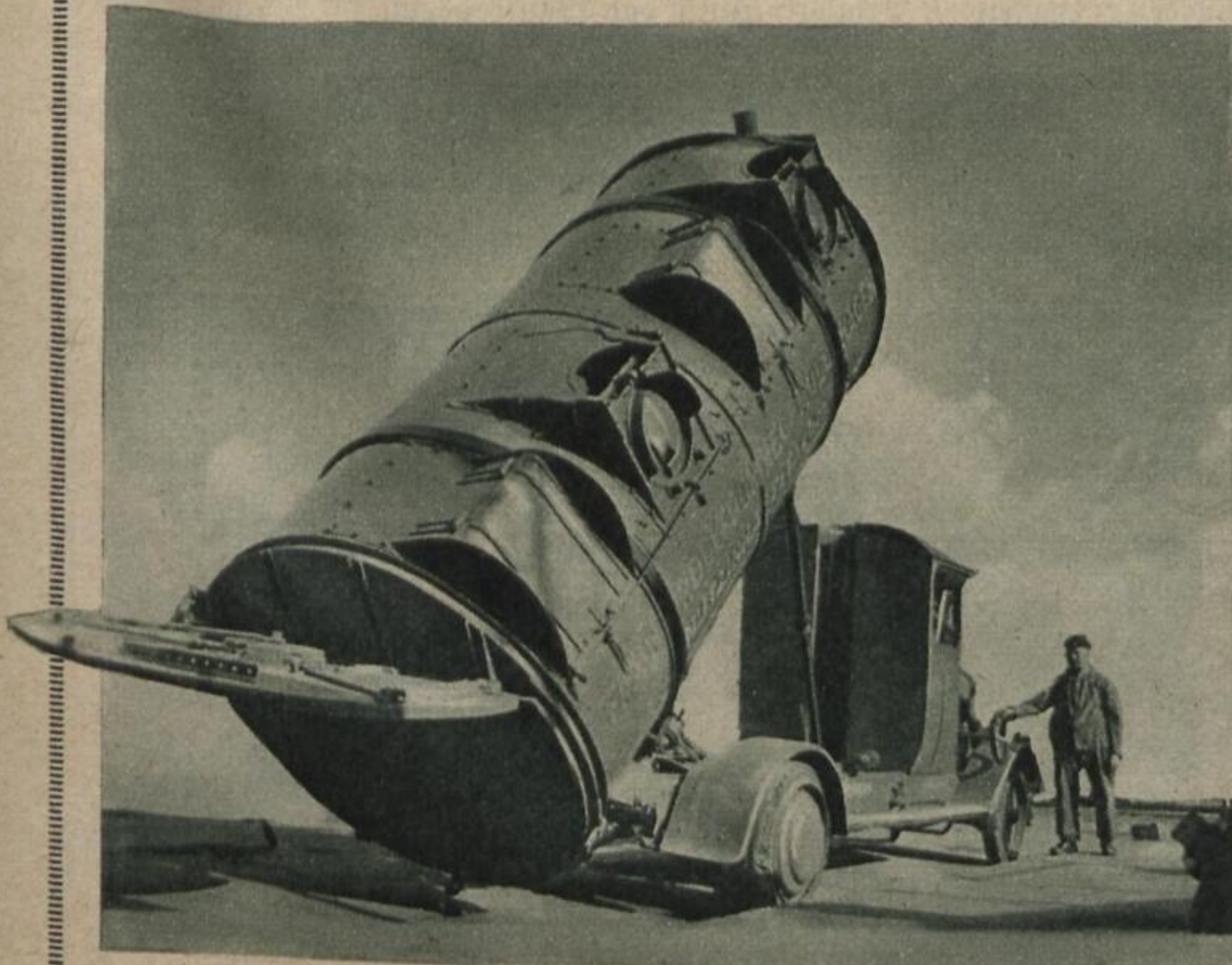
Eine staubfreie Müllabfuhr gestattet der Rolltrommel-Müllwagen. Die Müllkästen werden an der Seite eingeschüttet. Die Trommel wird im ganzen hochgekippt und kann so selbst wieder einfach entleert werden Fotoaktuell
