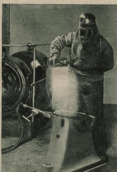
Der Arbeiter an der elektrischen Schweißmaschine wird durch Lederhaube mit Augengläsern, einen großen Lederschurz und lange Asbesthandschuhe vor den schädlichen Einwirkungen der Hitze und der ultravioletten Strahlen geschützt. Gleichzeitig wird durch diese Kleidung Verbrennungsschäden bei etwaigen Unfällen vorgebeugt
