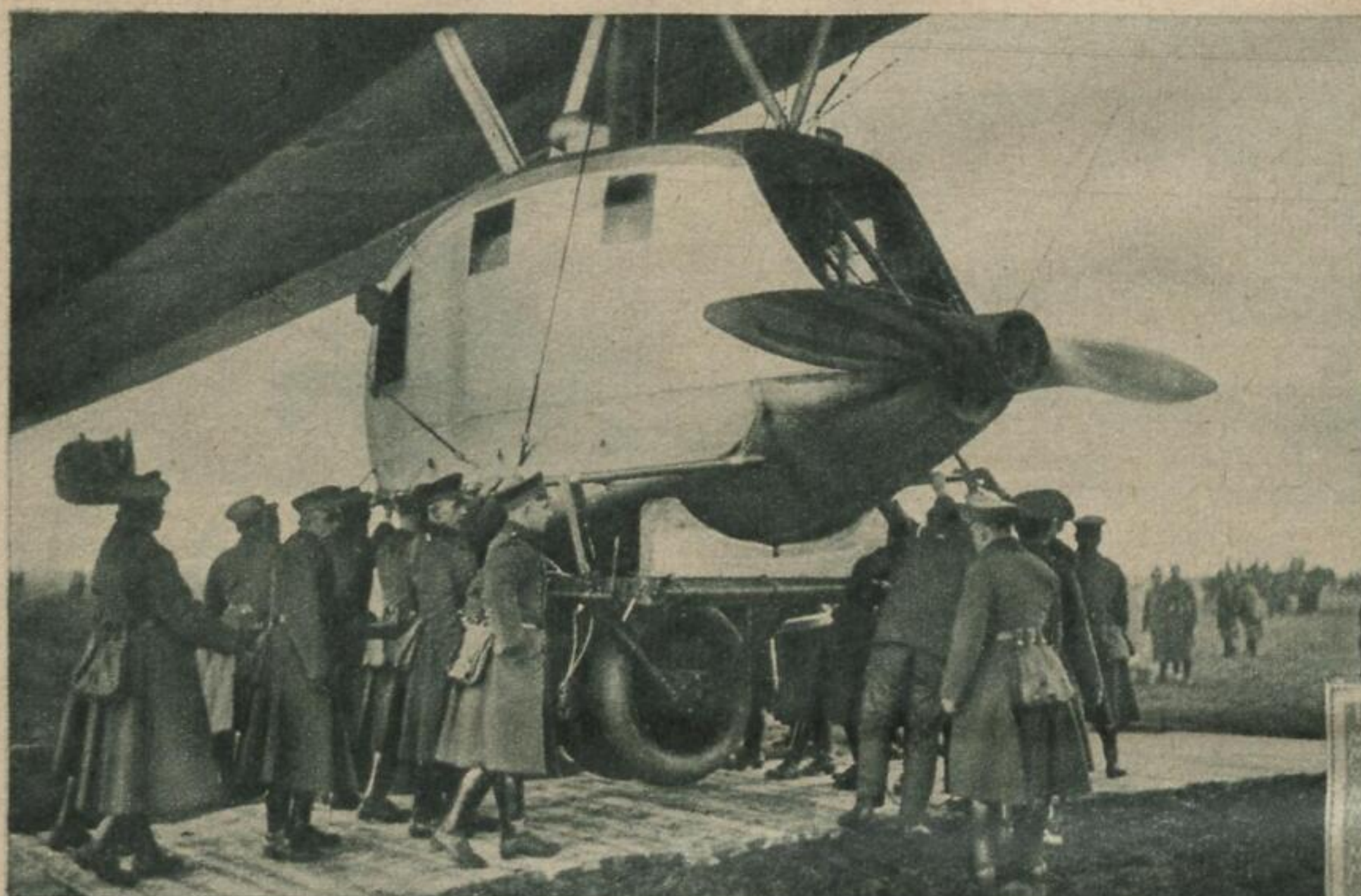
← Bild links: Das Heck des Luftschiffes ruht auf dem Boden, und zwar ist die hintere Motorengondel auf einem Fahrgestell befestigt. Die Räder des Gestelles laufen auf einem Kreise, so daß sich das Luftschiff am Ankermast im Winde bewegen kann Fotoaktuell Bild unten: Wie eine mit dem Zeppelin beförderte Postsendung aussteigt. — Eine vom Leipziger Messeamt nach Amerika mit „L. Z. 127“ gesandte Luftpostkarte
