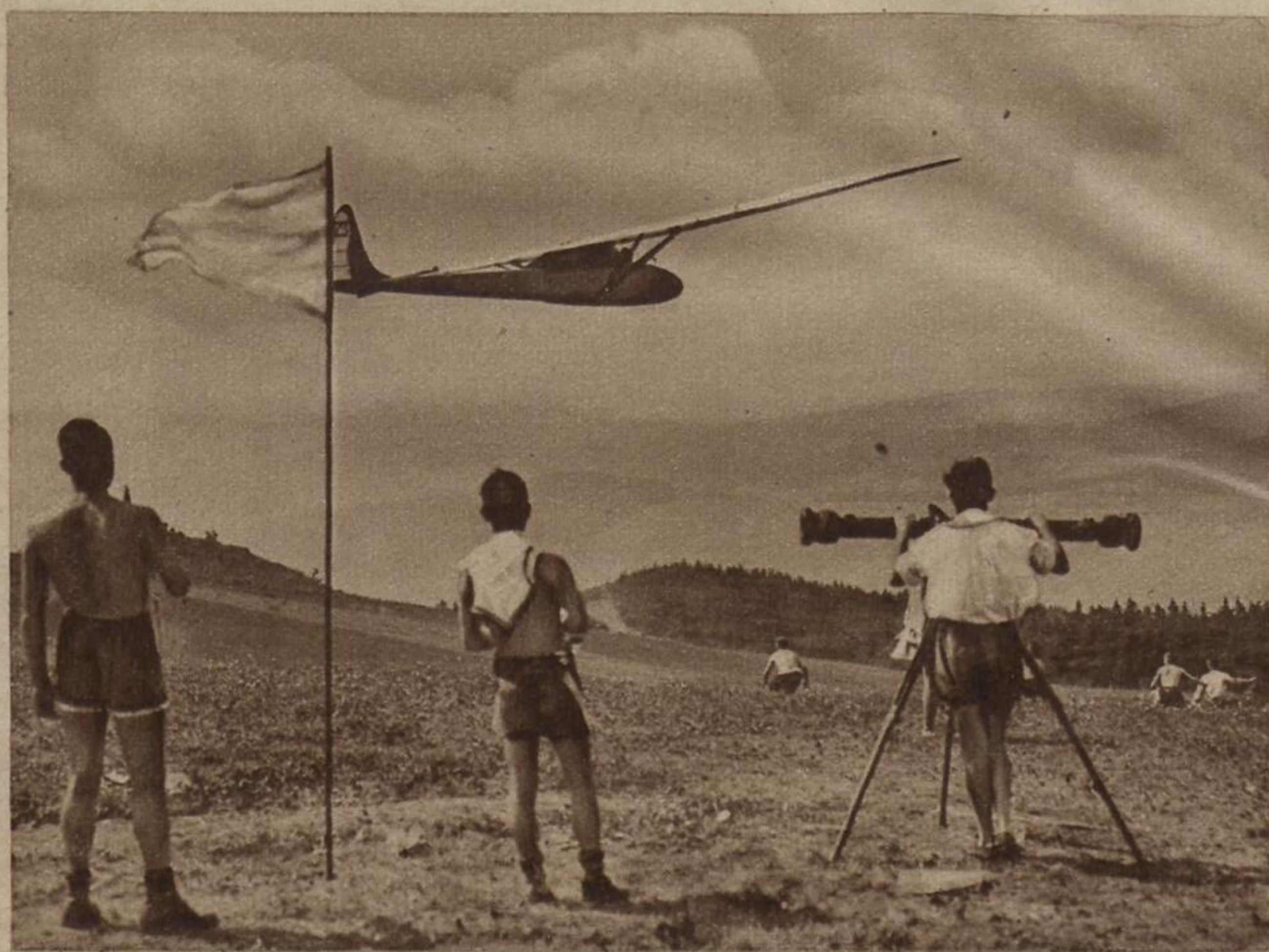
Mit dem Segelflugzeug über den Bergen der Rhön: der Messtrupp im Vordergrund stellt Höhe und Geschwindigkeit des Fluges fest Stöcker
