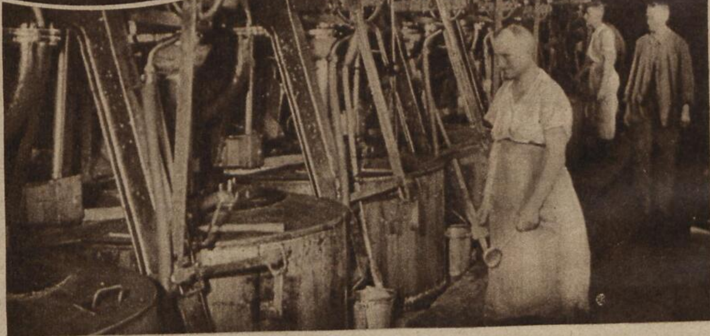
Bild rechts: → Zentrifugenstation zum Schleudern und Abwaschen des braunen Rohzuckers
