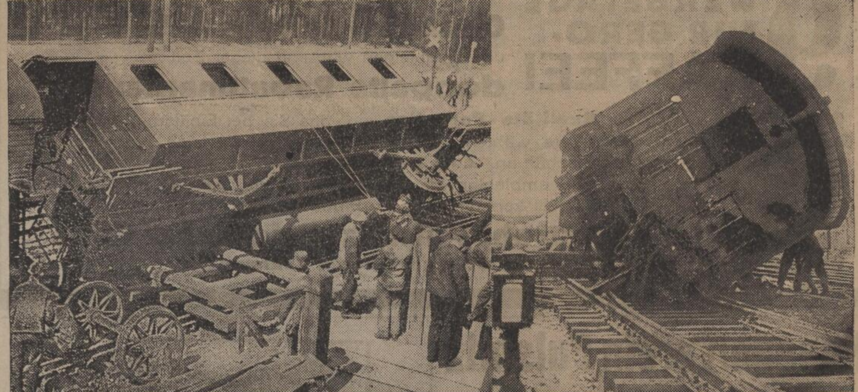
Auf der Strecke Reinhardtsdorf-Wandlitzsee der Niederbarnimer Eisenbahn, der sogenannten „Heidekrautbahn“, ereignete sich am Sonntag ein schweres Unglück. Zwei Wagen eines mit Berliner Ausflüglern voll besetzten Personenzuges entgleisten infolge falscher Weichenstellung bei der Ausfahrt aus der Station Basdorf.
