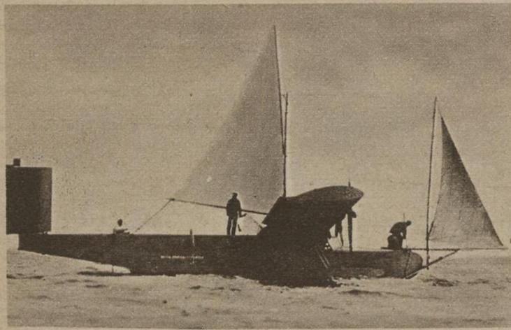
Das Kopenhagener Rohrbach-Leichtmetall-Flugboot, das kürzlich vier neue Weltrekorde aufstellte. Diese Konstruktion ist die erste, die es einem Flugzeug ermöglicht, sich im Notfall durch Segel auf dem Wasser fortzubewegen. Phot. Atlantic
