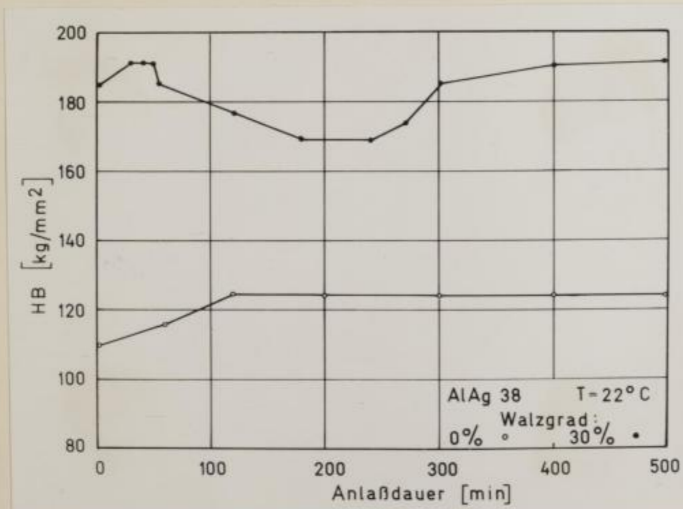
Bild 20 Verlauf der Härte in Abhängigkeit von Anlaßdauer und Walzgrad für T = 22°C (AlAg 38).
