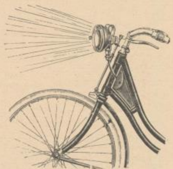
Modell III. Leichtestes u. zierlichstes Modell. Der Gasentwickler wird am Rahmen oder in der Werkzeugtasche getragen.
