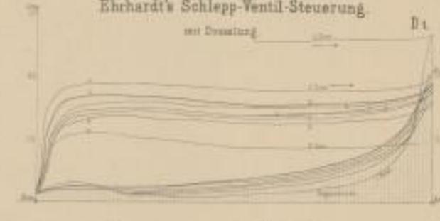
Diagramme einer Fördermaschine mit Ventil-Steuerung.
