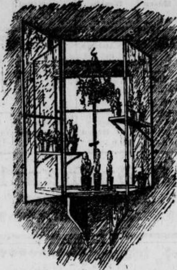
gut geschleierten Falz. Der Boden des Zimmergewächshauses besteht aus Zinkblech, das an den Rändern einige Centimeter hoch aufgehoben ist und dadurch ein Becken bildet, in welchem sich das ablauende Regenwasser sammelt.
