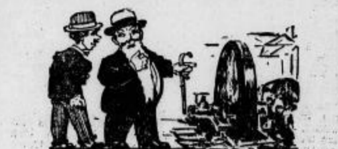
Bei der Dampfmaschine sorgt das Schwungrad für gleichmäßigen Gang. Im Geschäftsgetriebe nennt man dies Kraft Anker.
