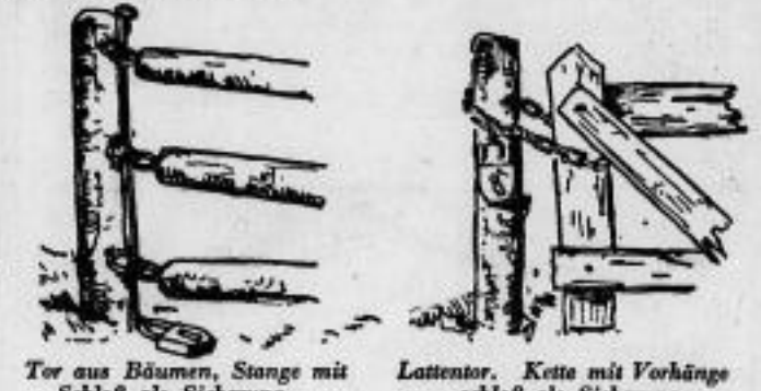
Tor aus Bäumen, Stange mit Schloß als Sicherung. Lattenor, Kette mit Vorhängen als Sicherung.
