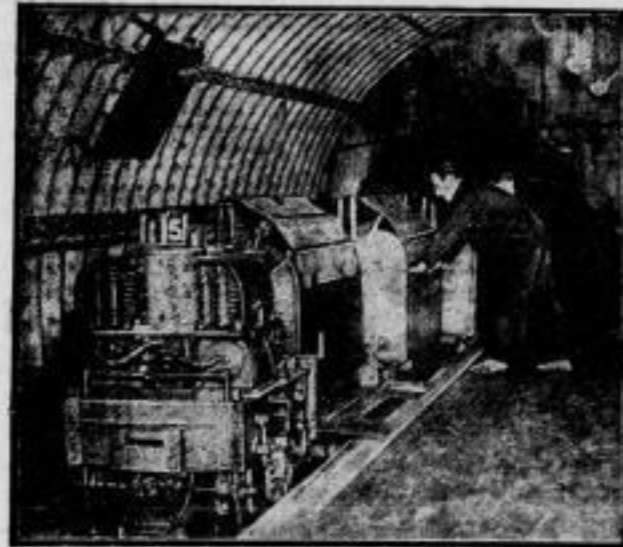
Wie der Londoner Postverkehr bewältigt wird. In London ist eine Post-Untergrundbahn eingerichtet worden, die sich über 11 Kilometer hinzieht und einen großen Teil des Londoner Postverkehrs bewältigt. Die Züge fahren selbsttätig ohne Führer und befördern täglich bis zu 80 000 Postfäden.
