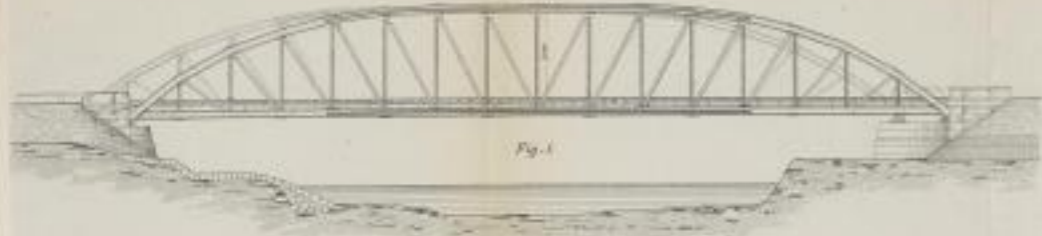
Montirungsgerüst des Thaya Viaduktes bei Znaim.
